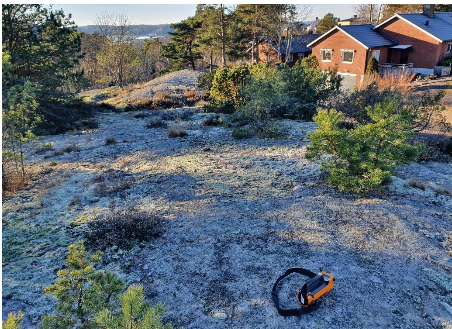
Figur 4.1.1. Spektrometern ställs på en platt yta minst 2x2 m stor. Mät punkt x4 i områdets västra del.
