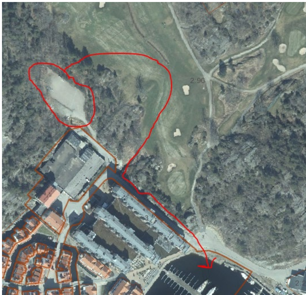
Bilden visar grusytan som ska bebyggas samt den väg vattnet sedan ska ta innan det når recipient.
