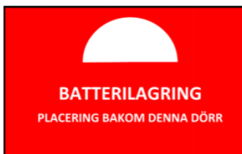
Figur 4. Förslag på skyltning för batterilager (Källa: Räddningstjänsten Storgöteborg, RSG).
