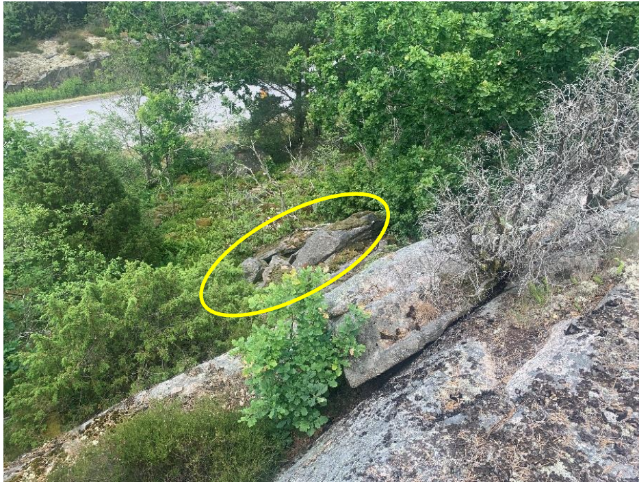
Figur 13. Slänt med skivor och utfallna block. Bild tagen mot nordväst från bergshöjden. Gul oval visar utfallna block.
