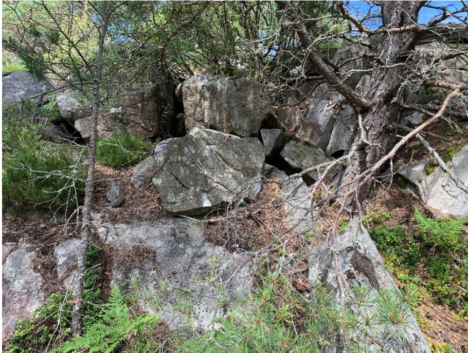
Figur 9. Lösa block i slänten. Blocken vilar stabilt på underlaget men kan destabiliseras vid schakt i anslutning till slänten.
