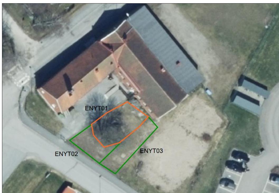
Figur 4. Inom ENYT01, markerad med orange linje, uppmättes de högsta krom- och zinkhalterna med XRF. Kartkälla ©Lantmäteriet 2022.
