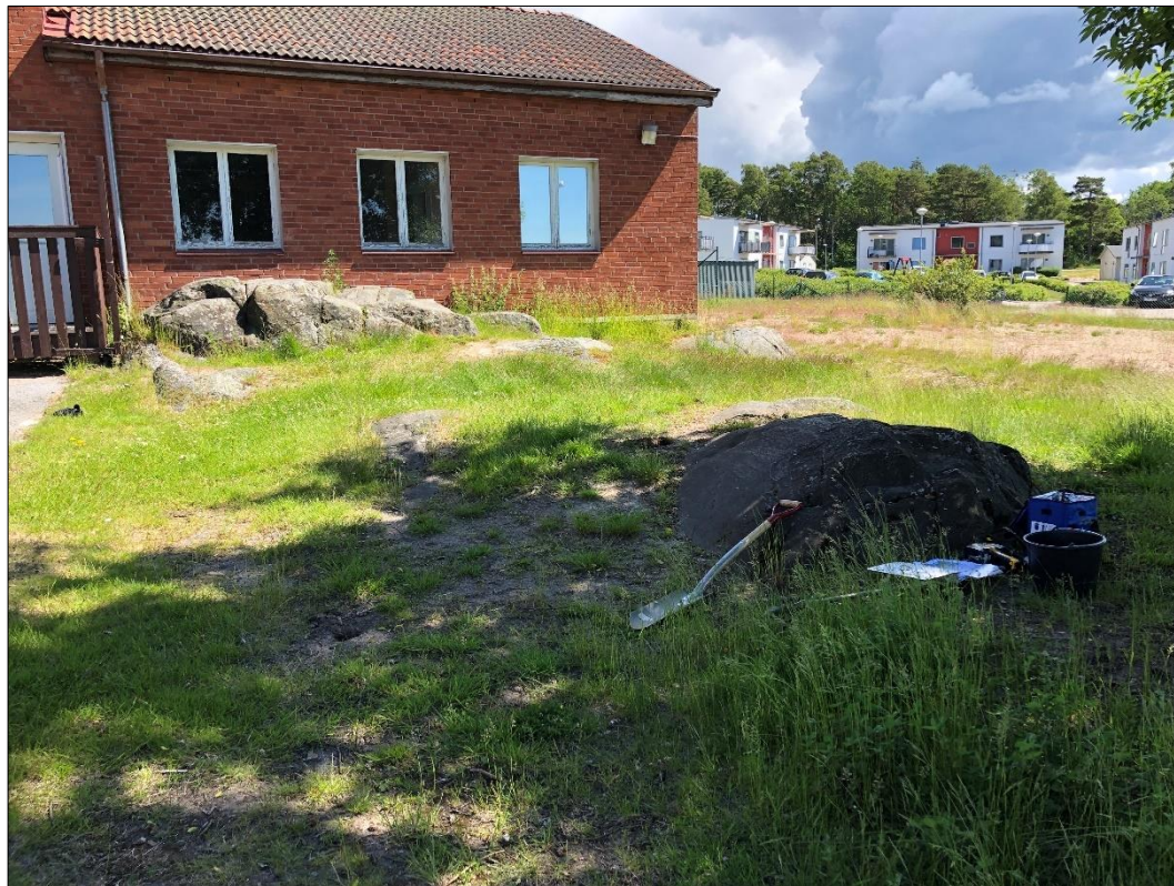
Figur 5. Jordtäcknet är tunt i anslutning till berghällan. Inom detta delområde påvisar XRF-mätningen de högsta krom- och zinkhalterna.
