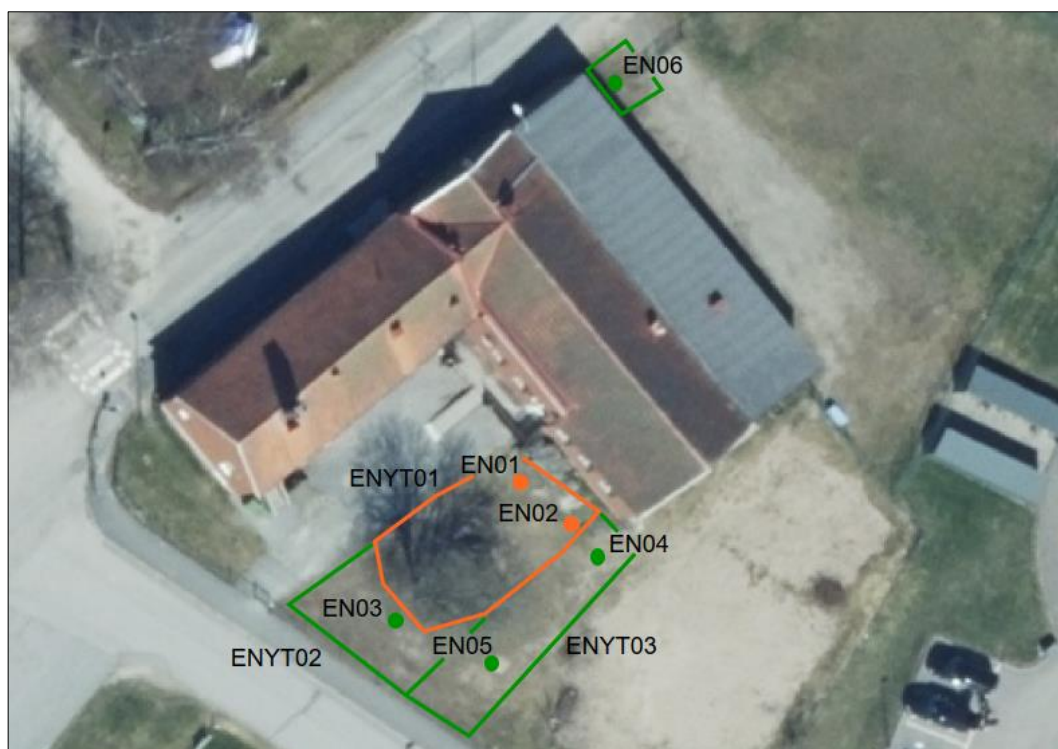
Figur 6. Översikt föroreningshalter. Halter över MKM=orange. Halter under KM=grönt. Kartkälla ©Lantmäteriet 2022.
